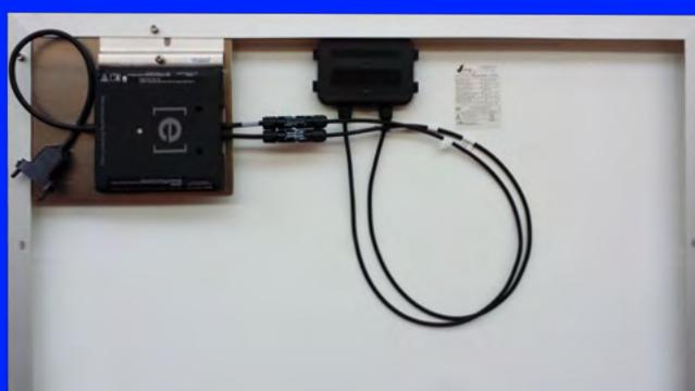
Il microinverter Enphase è un componente ad alta tecnologia elettronica e viene accoppiato in fabbrica a ciascun modulo fotovoltaico V-energy.
